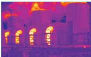
Tepelné úniky v parních zařízeních z důvodu nedostatečné izolace.
